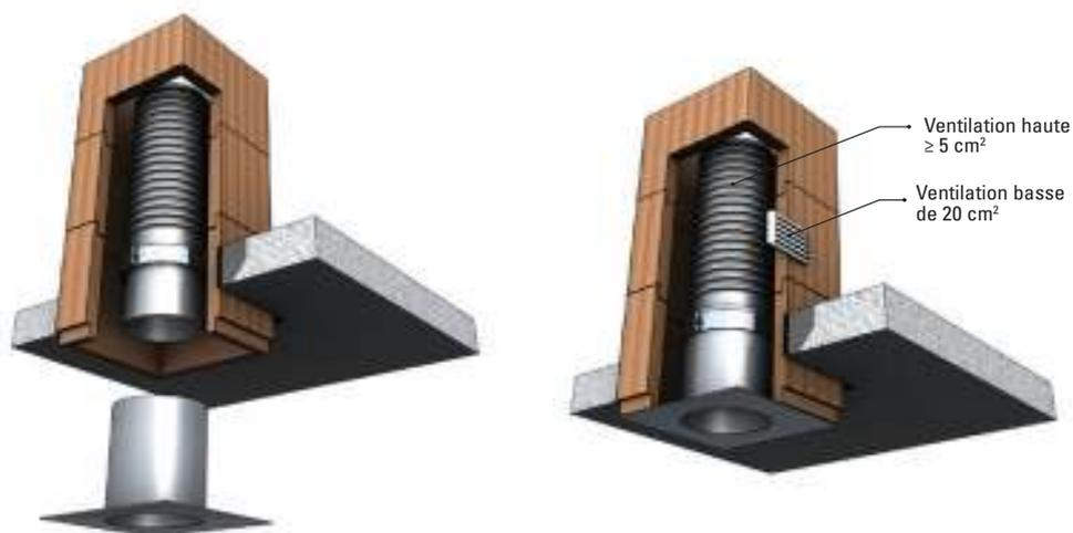
FIGURE 47 Mise en place du tubage et raccordement
